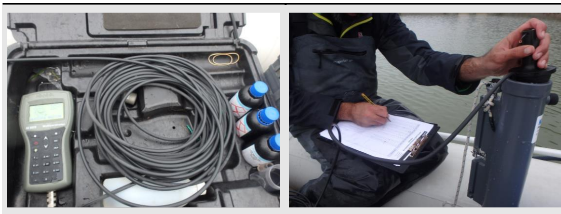
Fotografías 5.4.1.1.1-2. Análisis del perfil físico-químico de la columna de agua.
